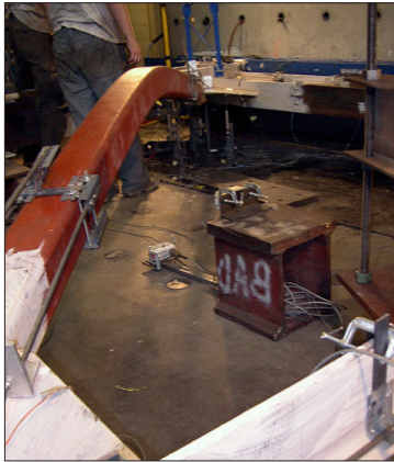
Şekil 1.5 : Merkezi çaprazlı çerçevelerde burkulma mekanizmaları ( [3]'den alınmıştır)
